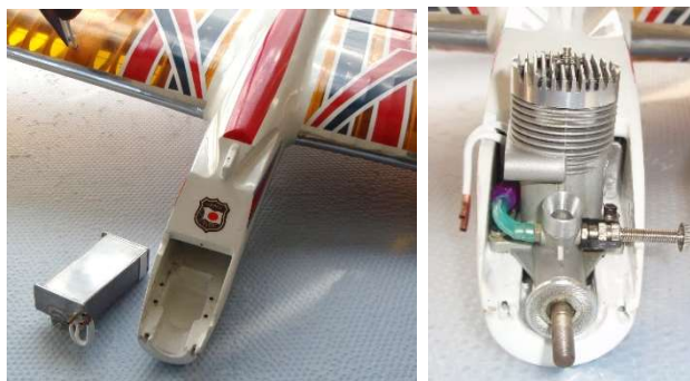
写真-9 左:機体の燃料タンク室 右:エンジン搭載
